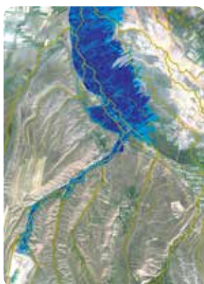
Modélisation de l'extension maximale d'une lame de 5 m de hauteur en cas de rupture de la digue du bassin à stérile de la mine de Makmal, Kirgizstan (en bleu clair).
