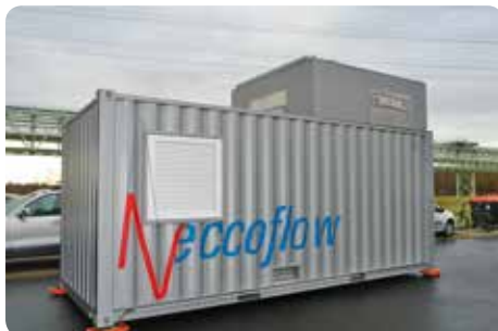
ECCOFLOW SFCL assemblé, prêt pour tests à RSE, Milan.
